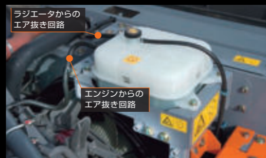
エキスパンションタンク
