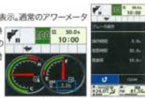
ブレーカアワーメータ ブレーカ操作画面
