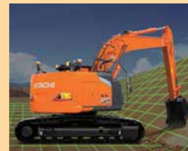
位置情報により掘削面を認識。
